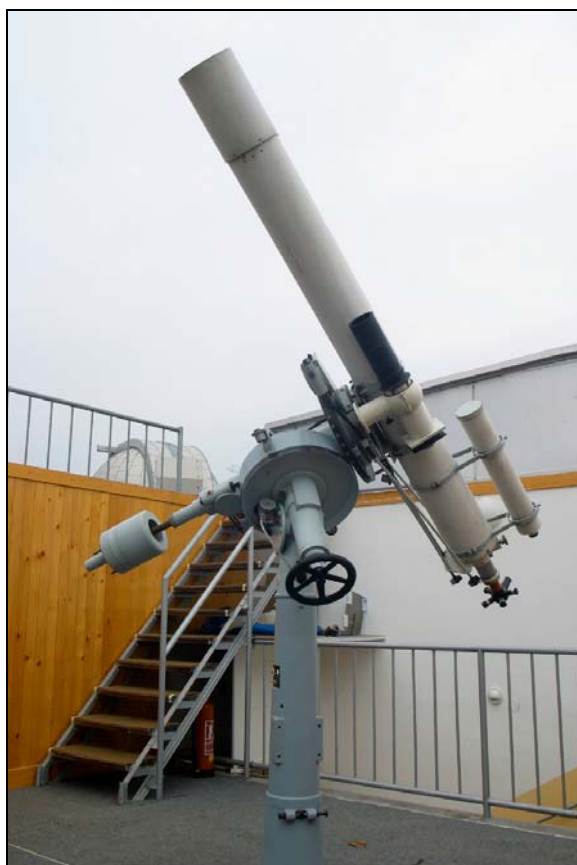
Refraktor o průměru objektivu 150 mm, ohnisková vzdálenost 2250 mm Hvězdárny a planetária Mikuláše Koperníka v Brně. Je umístěn na paralaktické montáži, polární osa je ve spodní části ukončena černým volantem. Foto: Jaroslav Luner.
